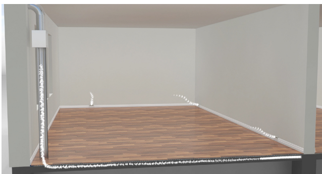
Kuvat 1-3. Tuloilma otetaan huoneilmasta tuloilmaventtiilien kautta ja poistetaan esimerkiksi erillisen tuulettimen avulla ulos rakennuksesta [7].
